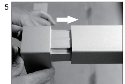
Halterung des Leuchtkörpers in Stange einführen
