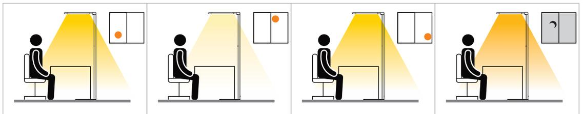
1. Licht und Dimmstufe auf eine angenehme Helligkeit einstellen. Der Tageslicht-Sensor wird den Lux-Wert auf dem Schreibtisch als Standard-Lux-Wert speichern.
