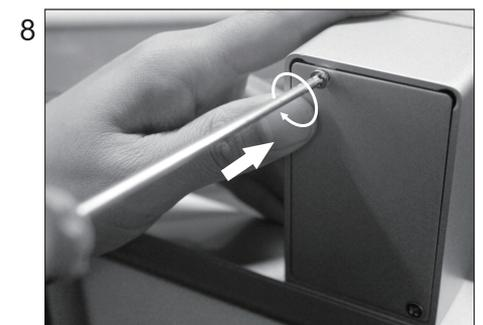
Box des Leuchtkörpers mit Schrauben verschliessen
