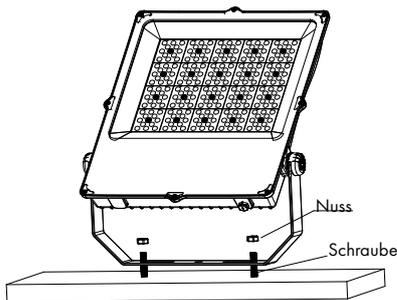
A. Bohrungen gemäss Grösstentabelle vorbereiten, Leuchte positionieren, mit Schrauben befestigen
