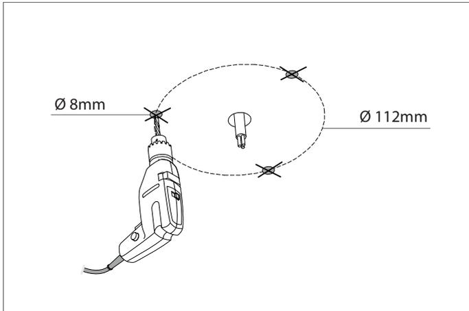
1. Drei Löcher bohren, gleichmässig auf einem Kreis verteilt
