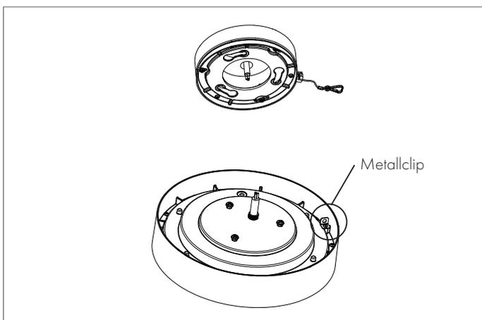
5. Fallsicherung am Leuchtenkörper befestigen (sicherstellen, dass der Strom ausgeschaltet ist)
