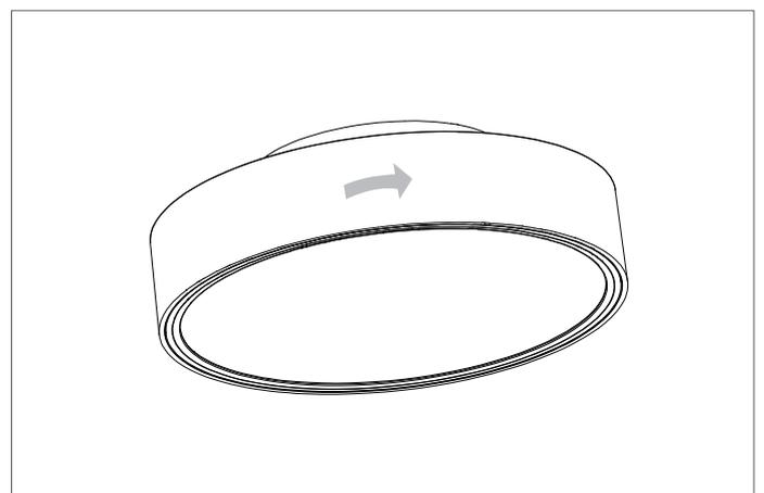
6. Leuchtenkörper ausrichten und im Uhrzeigersinn am Sockel einrasten
