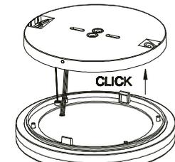
Leuchte in korrekter Position auf Befestigungsplatte installieren, auf wasserdichte Funktion achten
