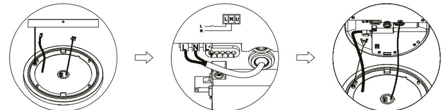
III. Wenn Sie einen Stromkreis hinzufügen, der von einer PIR-Leuchte gesteuert wird, schliessen Sie bitte die Drähte wie links gezeigt an.
