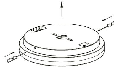
Befestigungslöcher auf beiden Seiten mit einem Werkzeug eindrücken, Befestigungsplatte abnehmen
