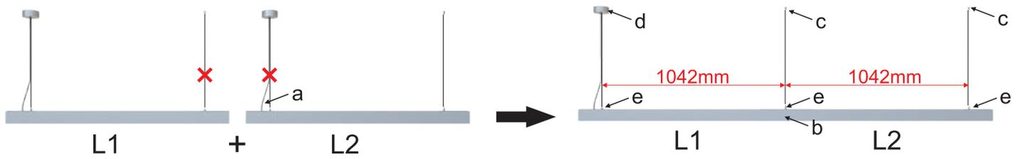
1 Wechselstromeingang (AC) unterstützt 10 miteinander verbundene Lampen
